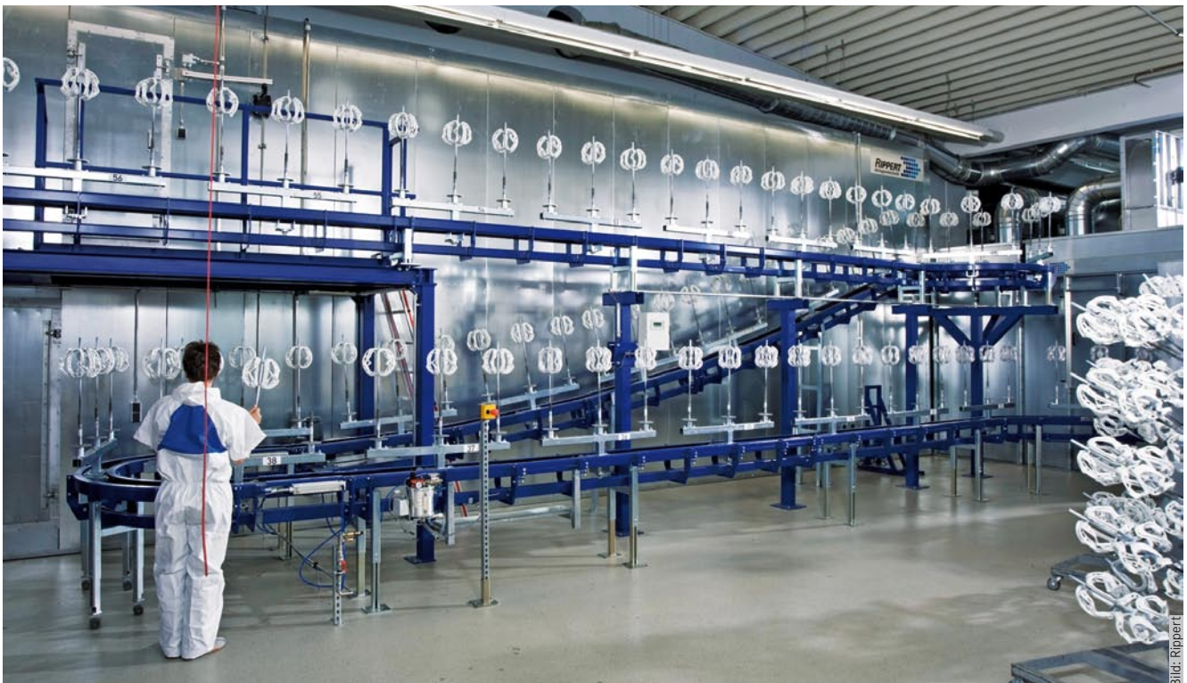
Die programmgesteuerte Drehung der Spindeln sorgt dafür, dass auch schlecht erreichbare Stellen der Werkstücke einwandfrei beschichtet werden
