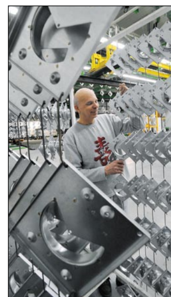
Die Teilaufgabe und -abnahme erfolgt an zwei Stationen, die jeweils mit einer Hub- und Senkstation versehen sind.
