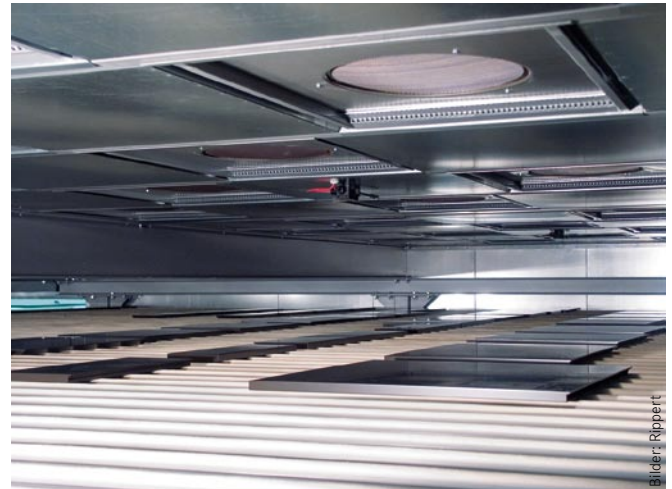
Der in drei Zonen unterteilte Trockner ist platzsparend ausgelegt und bietet eine sehr hohe Variabilität der Trocknungsparameter
