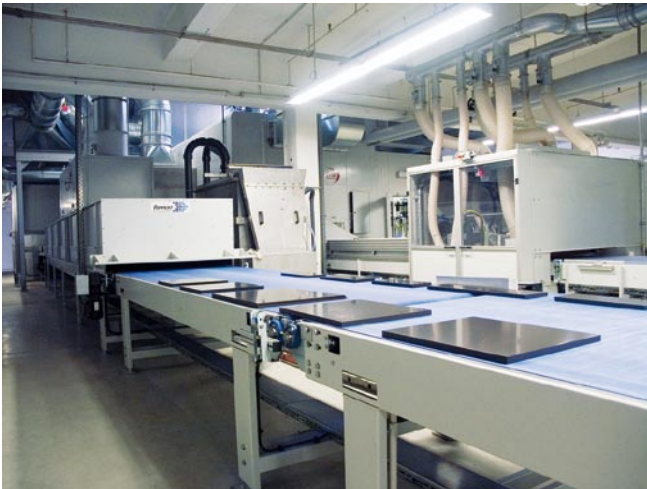
Die Holzteile verlassen den Kühlkanal mit einer Temperatur von <35 °C und sind sofort stapelbar
