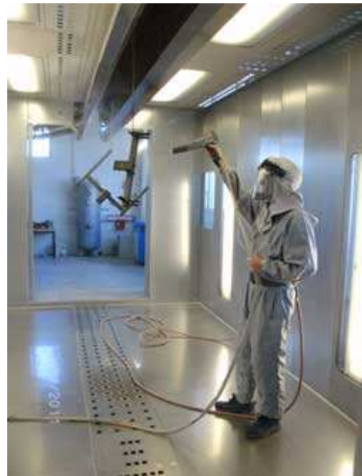
Der zweischichtige Lackaufbau, der aus einer Grundierung mit Epoxid-Pulverlack sowie einem Polyester-Strukturpulverlack besteht, erfüllt höchste Korrosionsschutzanforderungen.
