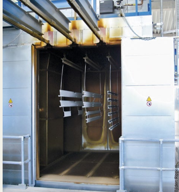
▲ Für den Einbrennprozess werden jeweils drei Traversen zu einer Charge zusammengefasst
