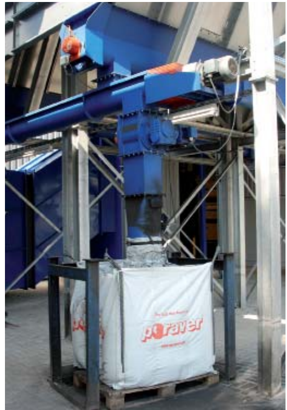
Bild 1: Über das Austragsystem kann das ausgefilterte Material in Big Bags verpackt oder dem Prozess wieder zugeführt werden.
