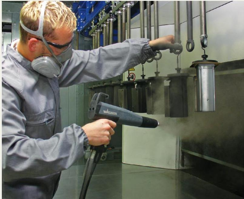
Der Pulverlack wird manuell auf die Servoantriebe aufgetragen
