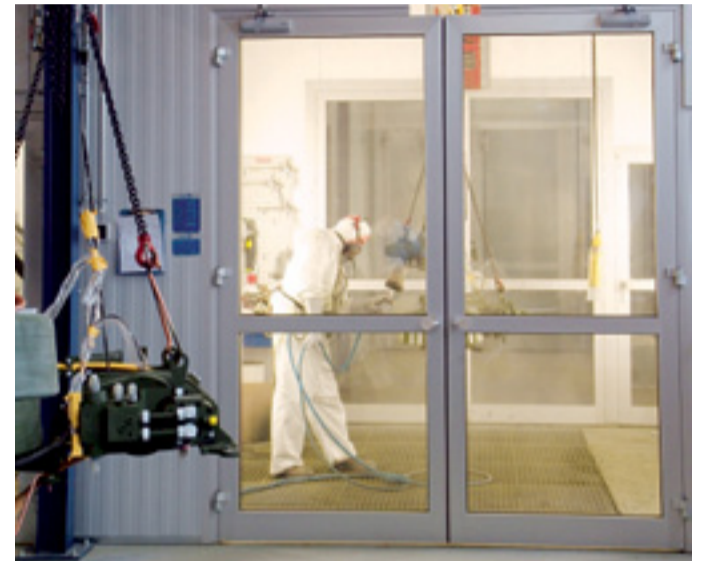
Die Werkstücke werden nach Durchlaufen des Haftwassertrockners in den Lackierkabinen manuell beschichtet. Quelle (zwei Fotos): Rotzler
