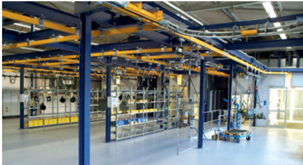
Bei der Fördertechnik hat sich Rotzler für ein halbautomatisches System entschieden, da es einen flexiblen Materialfluss ermöglicht und der großen Variantenvielfalt der Produktionsteile gerecht wird.
